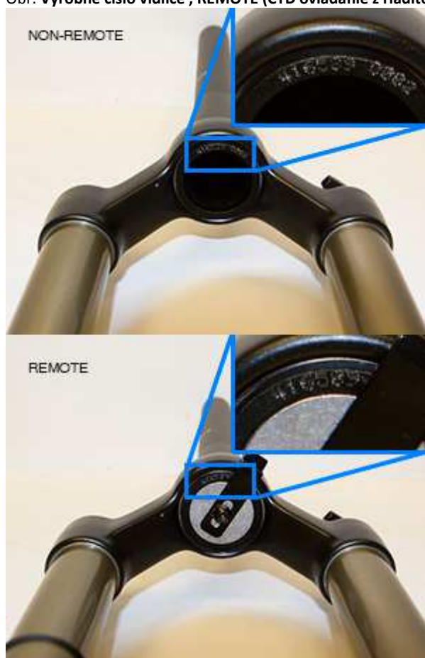
Obr. Výrobné číslo vidlice , REMOTE (CTD ovládanie z riadítok ) , NON-REMOTE ( manuálny CTD systém )
